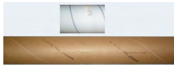
Abbildung 19: Unterschiedliche Breiten der Hartpapierstreifen bei der Hülseherstellung. Oben 150 mm Streifenbreite, unten 450 mm.
