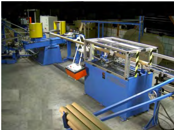
Abbildung 21: Spiralhülsenwickelmaschine. Quelle: www.guschky.com
