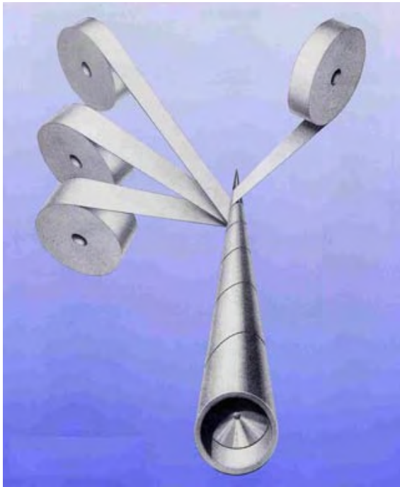
Abbildung 20: Schema der Spiralhülsenwicklung. Quelle: www.guschky.com
